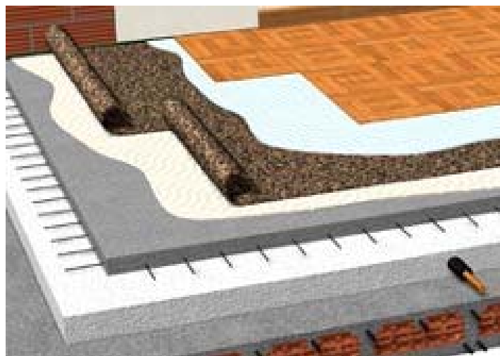
Figura C.3.2 Schema di applicazione del manto Cir-Fonicpav gold incollato tra il massetto ed il pavimento in parquet
